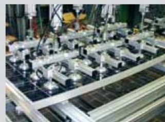
Test de charge des panneaux AluTec-System ©TÜV Rheinland, Allemagne
